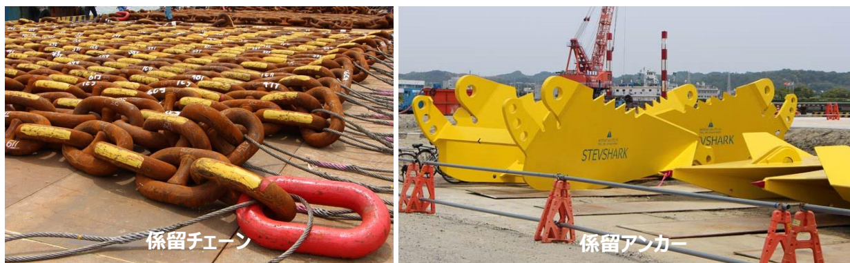
図 2.6-13 本実証事業にて用いた係留チェーンと係留アンカー
