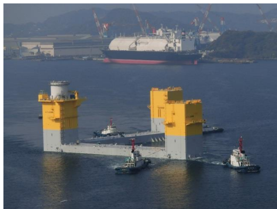
長崎港から曳航される 7MW 級風車搭載用浮体
