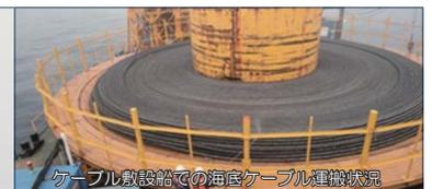
ケーブル敷設船での海底ケーブル運搬状況
