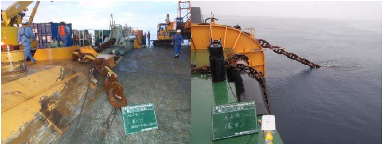
図 2.5-15 引張試験の様子
