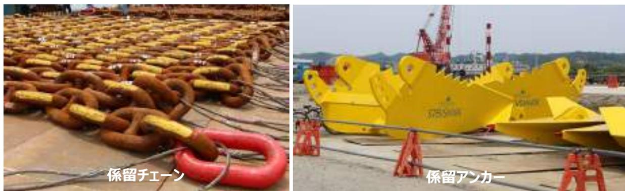
図 2.5-13 本実証事業にて用いた係留チェーンと係留アンカー
