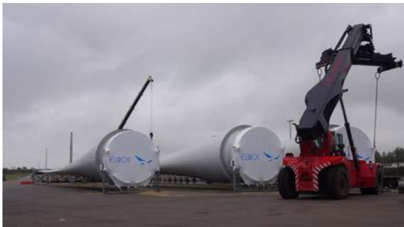
7MW 油圧ドライブ風車ブレードの輸送
